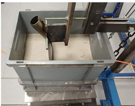
Figuur 5. De testopstelling met OV 2025-044 en 5 cm zanddek (links) en OV 2025-049 en 15 cm zanddek (rechts).
