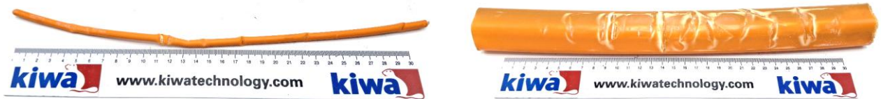
Figuur 3. OV 2025-044 (links) en -046 (rechts) na de praktijktesten waar vijftien personen meerdere keren (blind) in de bak met zand hebben gestoken of geschopt.
