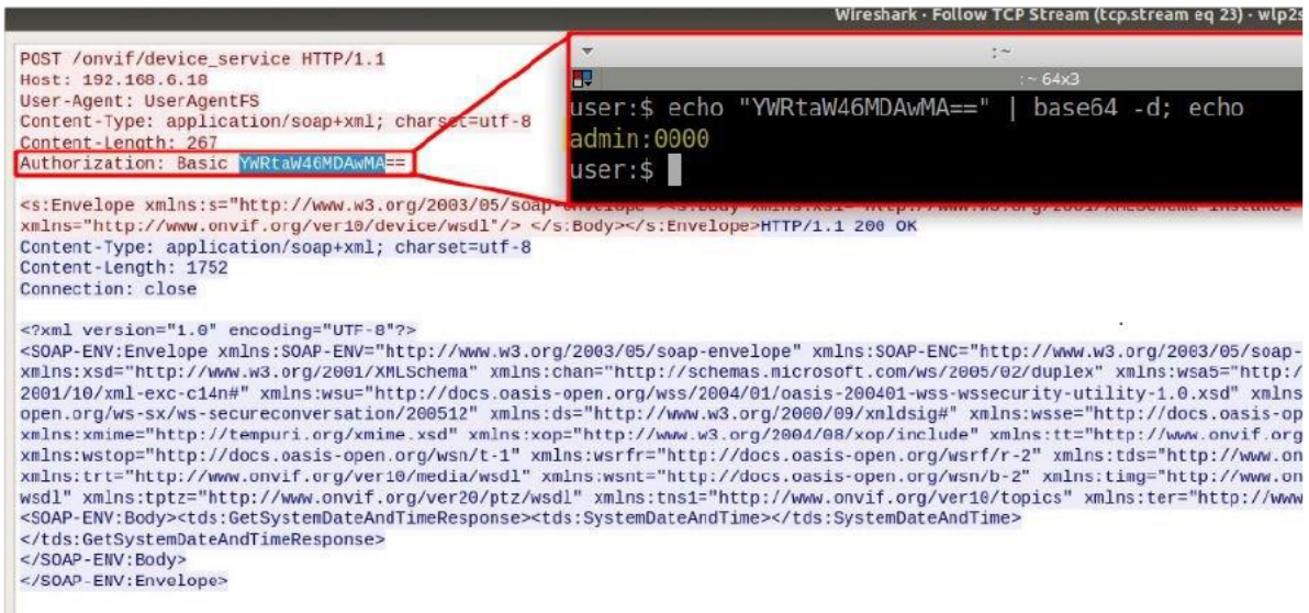
Figuur 12 Poging om verbinding te maken met de ONVIF-ingang van een babyfoon met eenvoudige gebruikersnaam en wachtwoord
