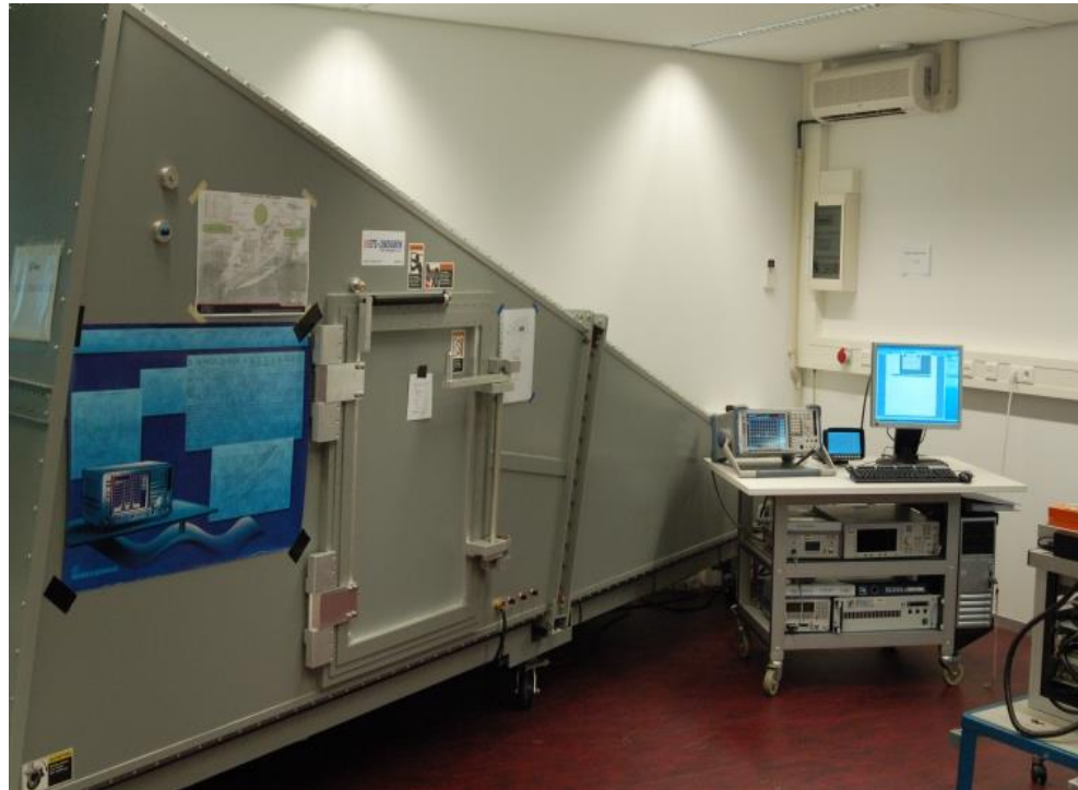
Figuur 3. Meetopstelling immuniteit; GTEM (Gigahertz Transverse Electromagnetic Cell)
