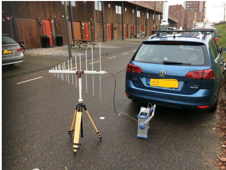
Figuur 2 : Buiten meten wat uit een huisinstallatie komt
