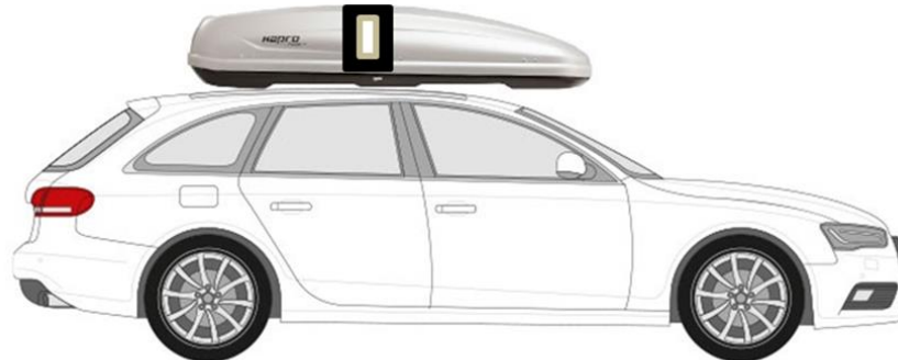
Figuur 5 - Opbouw meetopstelling – dakkoffer met smartphone (grijs) in geconditioneerde box (zwart)
